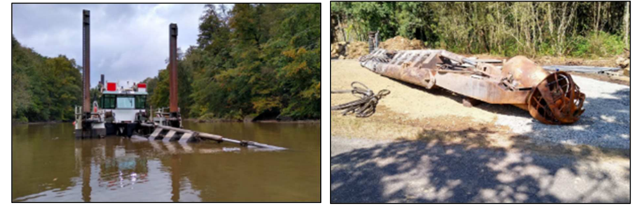
FIGURE 53 - DRAGUE ASPIRATRICE STATIONNAIRE ET SON CUTTER (SOURCE : INGEROP, 2020)
