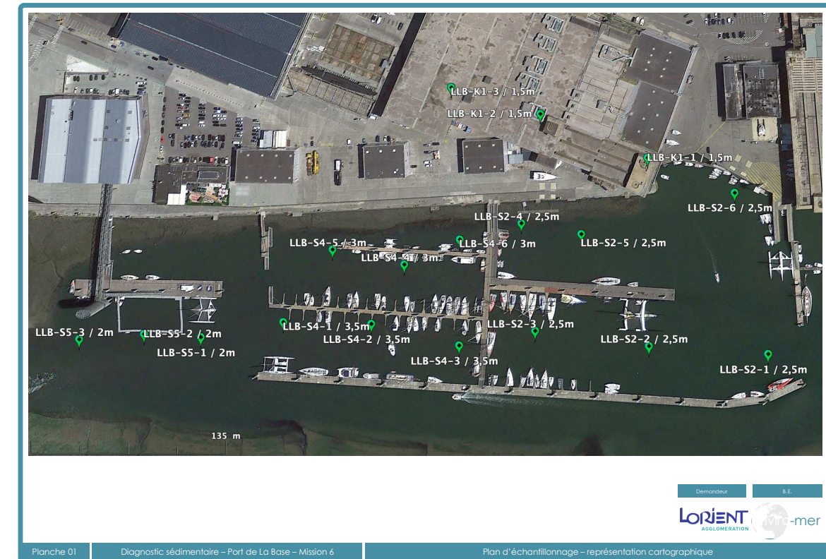
FIGURE 48 - PLAN D'ÉCHANTILLONNAGE DES SÉDIMENTS DU PORT DE LORIENT LA BASE - 2019
